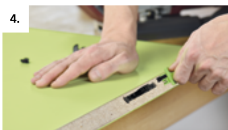
Vorspann-Clip eindrücken zum einfacheren Zusammenfügen der Bauteile.
