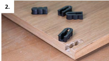
Verbinder auf dem Bearbeitungszentrum fräsen oder bohren
